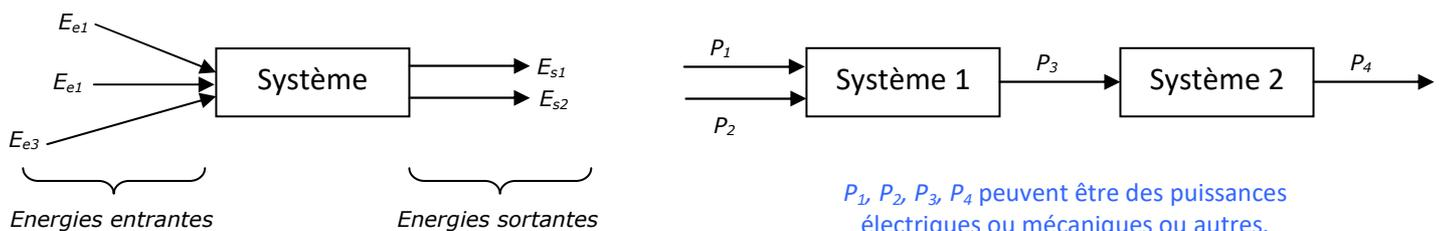
$P_1, P_2, P_3, P_4$  peuvent être des puissances électriques ou mécaniques ou autres.
